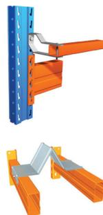
Des butées de palettes peuvent être utilisées dans les rangées simples ou doubles. Elles sont souvent mises en place pour protéger le mur du bâtiment, par exemple pour les cloisons des chambres froides, ou pour garantir l'espace entre les palettes dans les rayonnages doubles des installations sprinklées. Les butées tubes peuvent également être utilisées comme support de fixation d'un habillage (bardage) sur la face arrière des rangées.
