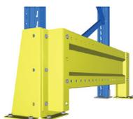
Un trafic intense sur les extrémités des rayonnages, voire dans les passages pont, occasionne souvent des dommages à l'installation. La protection d'extrémité Stow est composée d'une lisse principale en profil sigma, boulonnée sur deux pieds. Des pieds intermédiaires sont rajoutés pour des longueurs plus importantes.
